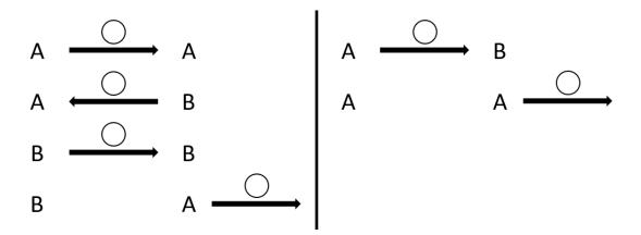
この図から,、状態 A の装置 E の右端からボールが飛び出してくる」状況においては,E の状態は E の右の装置の元々の状態と反対の状態になり,E の右の装置が状態 A になって,その装置の右端からボールが飛び出してくる状態に変化することがわかる. さらに,装置 N は最終的には必ず状態 A になることもわかる.
